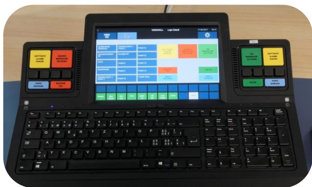
Клавиатура WEYTEC Smart Touch – многофункциональная клавиатура с настраиваемыми клавишными блоками, расположенными справа и слева от экрана клавиатуры
